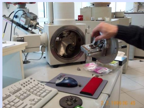
Camera ad alto vuoto di un microscopio elettronico a raggi X ESEM con sonda EDAX
